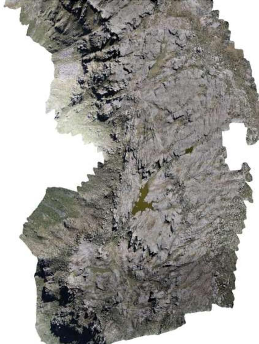
Una ortofotografía es producida por un mosaico de imágenes capturadas con drones volando a baja altura, y procesadas con software de fotogrametría. La imagen producida es una proyección ortogonal, sin distorsiones. Tiene la misma precisión que un plano y permite todo tipo de mediciones.
